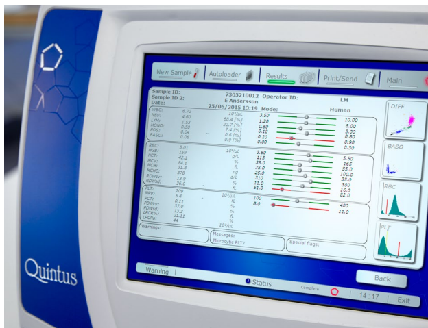
Espacio suficiente para mostrar todos los resultados de 26 parámetros, además de diagramas de dispersión e histogramas, advertencias, mensajes e indicadores.
